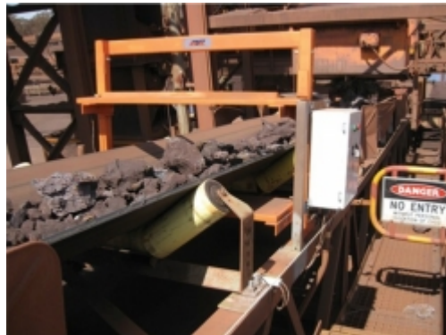
شکل ۱: فلزیاب مخصوص سنگ آهن با عیار بالا
