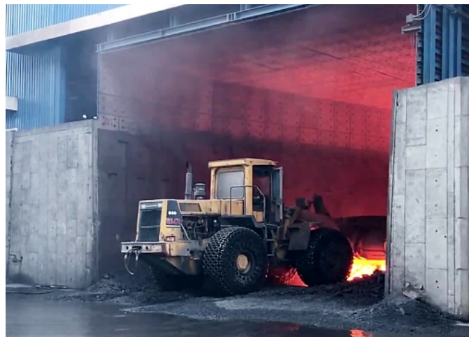
تخلیه سرباره از تونل سرباره توسط لودر
